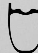
Dieser Reifen ist bis zu einem begrenzten Maximaldruck geeignet für Hookless-Felgen. Bitte beachten Sie die Montageanleitung und die Reifenverpackung für detaillierte Informationen.
